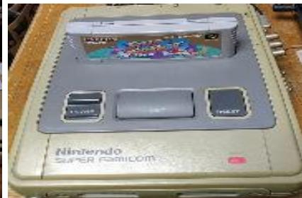
スーパーファミコンには当初、パソコンモニタを繋げるべく回路を内蔵させたり、本体横にRCAジャックを付けたりしましたが、いまは21PのRGBケーブルをXRGB-1というアップスキャンコンバーターに繋ぐことで、VGA対応のPCモニタでキレイに映るようになったのでこの形で展示をしようと思います。
